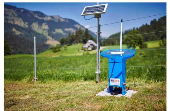
Hagelsensor im Napfgebiet mit Solarmodul, Antenne und Blitzableiter. Funktionsweise: Beim Aufprall eines Hagelkorns auf dem Sensor beginnt die Makrolonscheibe aus extrem robustem Kunststoff gefertigt zu schwingen. Diese Schwingungen werden durch ein hochsensibles Mikrofon aufgezeichnet, das sich unter der Scheibe befindet. Die Daten werden auf dem Sensor zwischengespeichert und anschliessend via Mobilnetz an einen zentralen Speicherort bei der MeteoSchweiz übermittelt.
